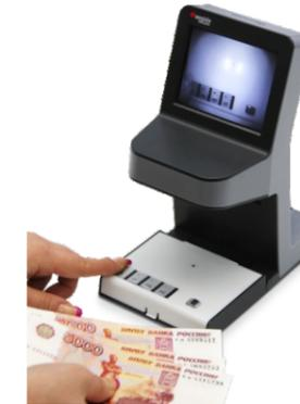
Cassida UNOplus оснащен магнитным датчиком, позволяющим проверить магнитные метки на банкнотах.
