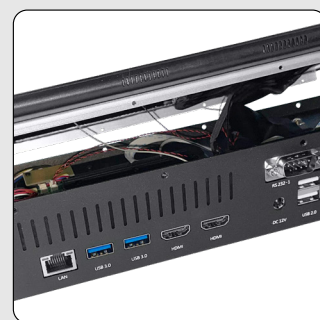
Улучшенная ремонтпригодность: экран легко снимается, крепится на 8 винтах
