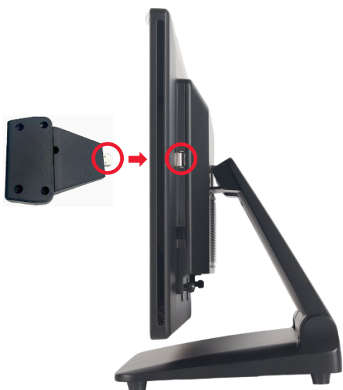
Рисунок 8. Ридер магнитных карт и разъём для подключения ридера магнитных карт
