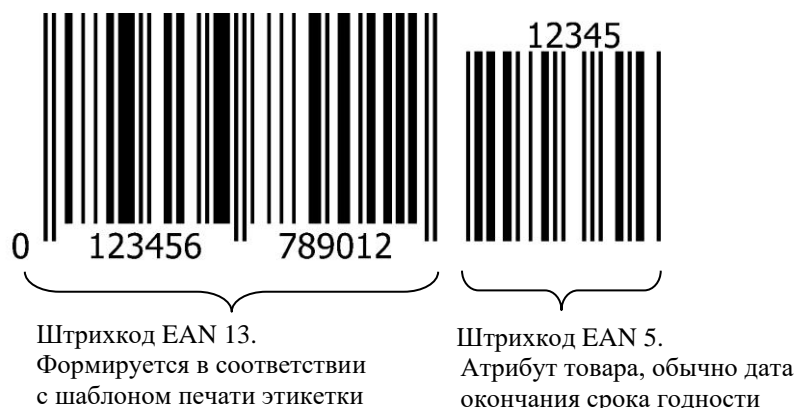
Рис. 6.2 – Структура штрихкода EAN 13+5
