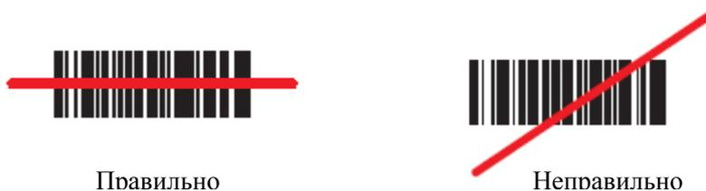
**Рисунок 3-2** Лазерное сканирование
