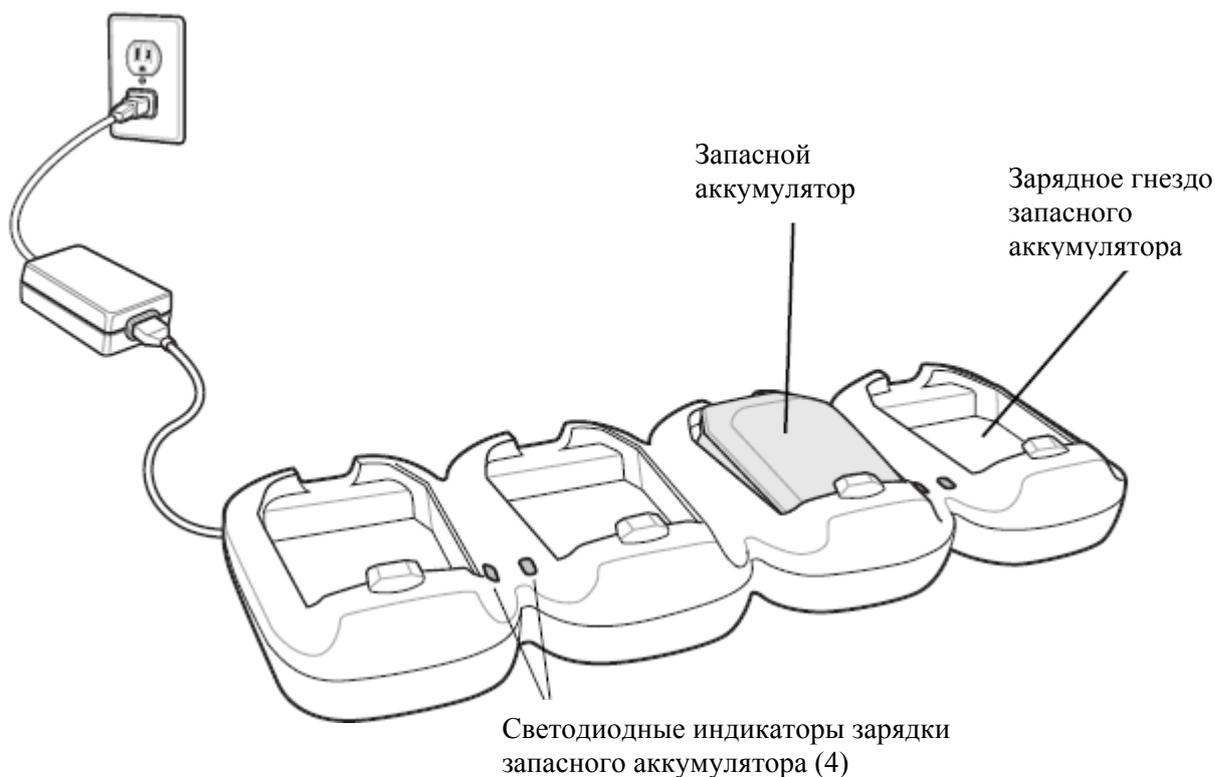
**Рисунок 6-4** Зарядное устройство с 4 гнездами
