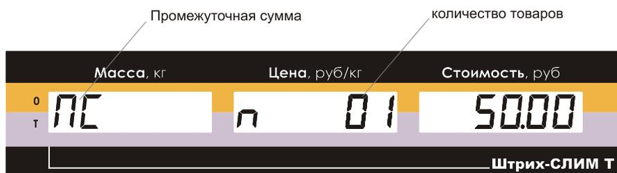
Рисунок 60. Показания дисплея в режиме "Промежуточная сумма".
