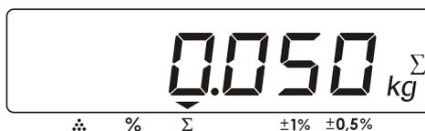
Рисунок 36. Показания дисплея при добавлении веса в сумматор.
