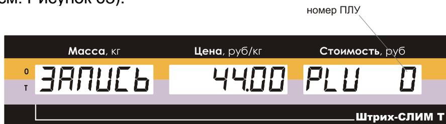
Рисунок 63. Показания дисплея в режиме "Программирование ПЛУ".
