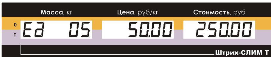
Рисунок 59. Показания дисплея при введенном количестве штучного товара.
