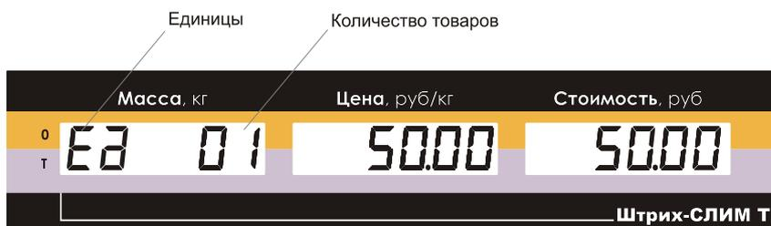
Рисунок 58. Показания дисплея в штучном режиме.
