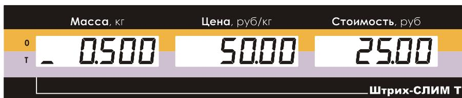
Рисунок 56. Показания дисплея после взвешивания товара в таре.
