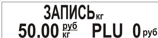
Рисунок 50. Показания дисплея в режиме "Программирование ПЛУ".
