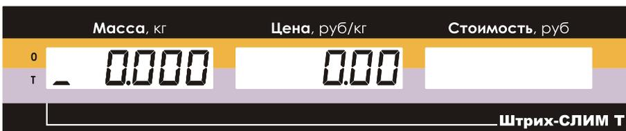
Рисунок 55. Показания дисплея после выборки массы тары.
