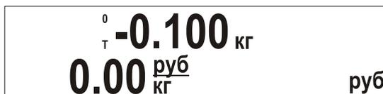
Рисунок 41. Показания дисплея при введенной известной массе тары.
