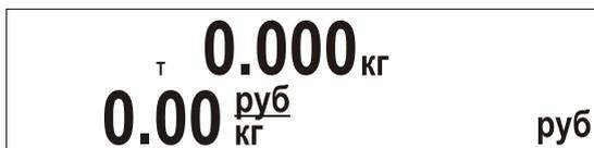
Рисунок 42. Показания дисплея после выборки массы тары.
