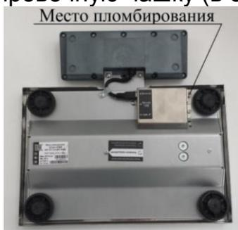
пломбировочная чашка устанавливается на днище весов (индексы: ДМ1, ДМ2.1, ДМ2.2, ДП1, ДП1.1, ДП2.1, ДП2.2, ДП3, ДП4, ДП5, К)
