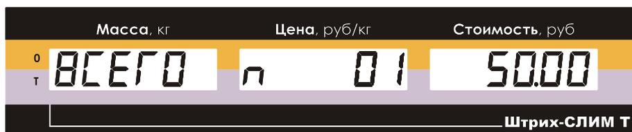
Рисунок 62. Показания дисплея в режиме "Итоговая сумма".
