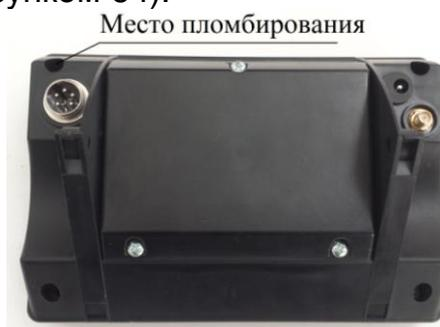
пломбировочная чашка устанавливается на задней крышке терминала (индексы: ДП3, ДП4, ДП5)
