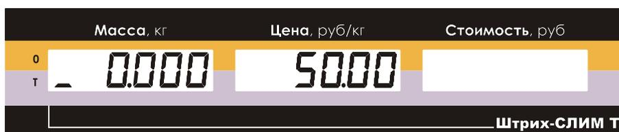
Рисунок 57. Показания дисплея после добавления текущего значения массы товара в тару.
