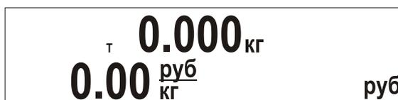
Рисунок 39. Показания дисплея при введенной неизвестной массе тары.
