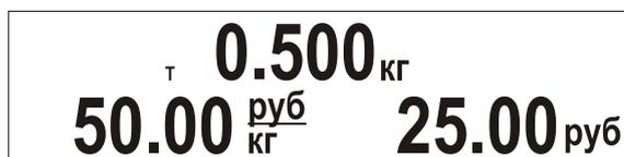
Рисунок 43. Показания дисплея после взвешивания товара в таре.
