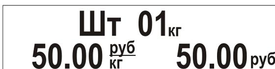
Рисунок 45. Показания дисплея в штучном режиме.
