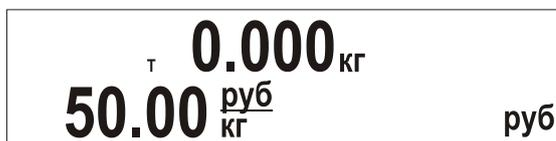
Рисунок 44. Показания дисплея после добавления текущего значения массы товара в тару.
