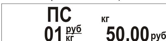
Рисунок 47. Показания дисплея в режиме "Промежуточная сумма".
