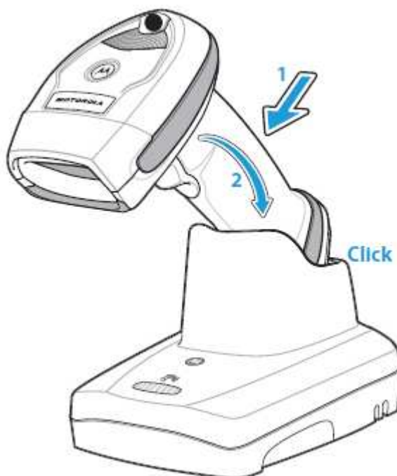
Рисунок 1-12 Вставка сканера в стационарную базовую станцию
