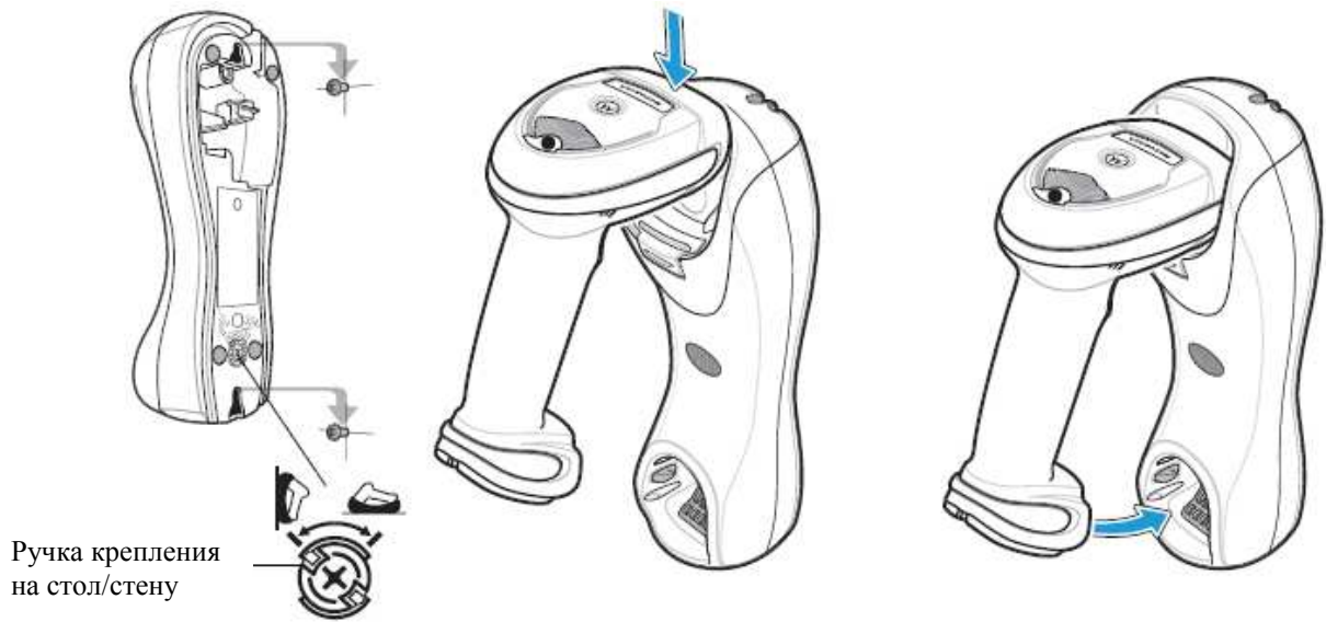
Рисунок 1-11 Вертикальная установка – вставка сканера в базовую станцию
