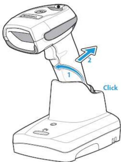
Рисунок 1-13 Извлечение сканера из стационарной базовой станции
