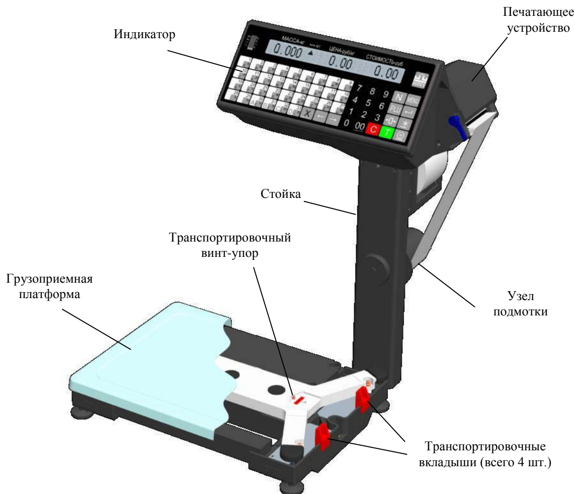
Рис. 3. Общий вид весов ВПМ_Т1
