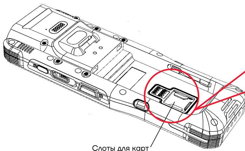
Рисунок 7. Расположение слотов для карт SIM и micro-SD
