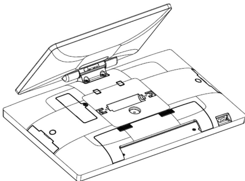
1. Расположите пос систему экраном вниз и открутите винт удерживающий заглушку для установки дополнительного монитора покупателя 10.1"
