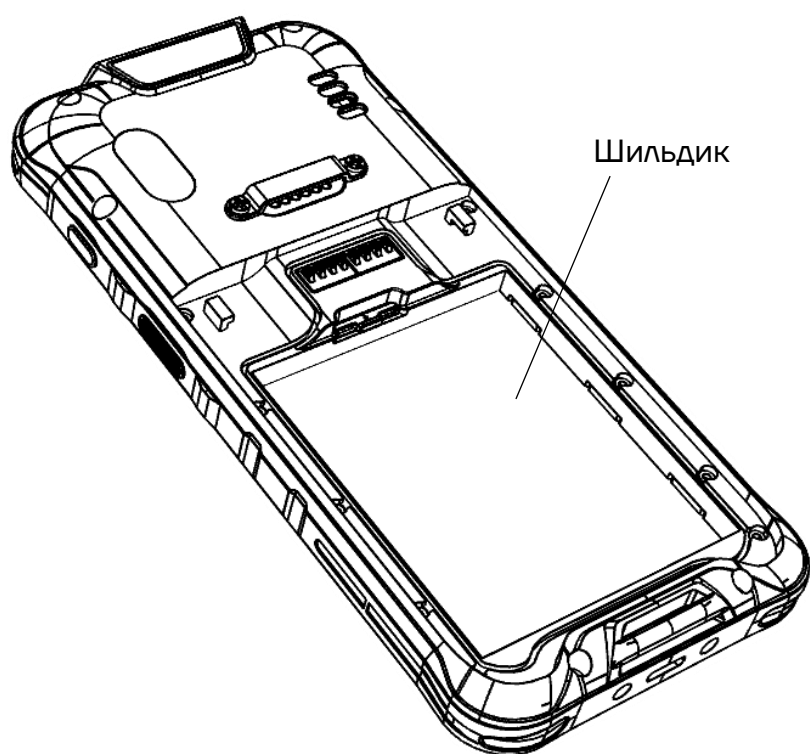
Рисунок 12. Место установки шильдика в отсеке для АКБ корпуса ТСД
