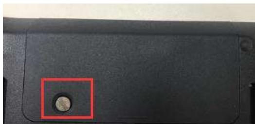
Снять крышку и вынуть батарею.
